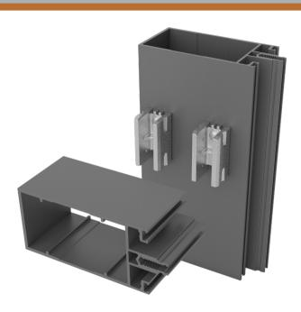
Staffa in alluminio pressofuso universale per il montaggio sequenziale di facciate continue. Costituito da un doppio cavallotto, può essere utilizzato per montare tutti i traversi della stessa serie, con larghezze differenti. Questo sistema elimina il laborioso fissaggio tramite viti e garantisce il preciso posizionamento grazie ai fori realizzati sul montante. Con pulsanti di ancoraggio fissi e serraggio di sicurezza tramite unica vite. **Brevettato.**
