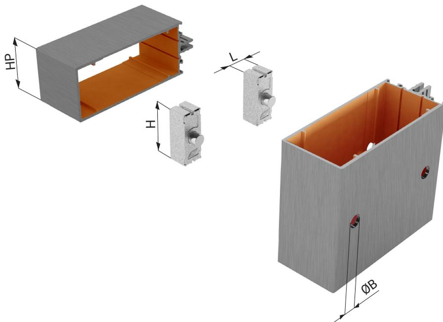
Cavalotto in alluminio pressofuso per facciate continue. Serraggio ad incastro e ancoraggio con pulsante a scatto. Semplifica e velocizza il posizionamento dei traversi. Per giunzioni a T ed a croce. **Attrezzatura di serraggio richiesta: martello.**
